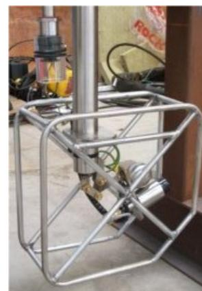
d tector de gases y camera video con luz
